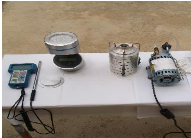
Εικόνα 5.1: Τα όργανα που χρησιμοποιήθηκαν στις δειγματοληψίες. Από αριστερά προς τα δεξιά απεικονίζονται τα όργανα: 1) VelociCalc (TSD), 2) MAS 100 (Merck Γερμανίας), 3) Andersen 6 επιπέδων.
