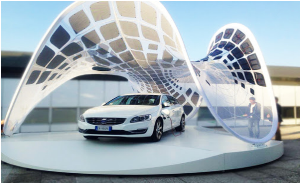
Σχήμα 1.43 Φόρτιση Ηλεκτροκίνητου οχήματος μέσω εύκαμπτων Φ/Β λεπτού υμενίου
