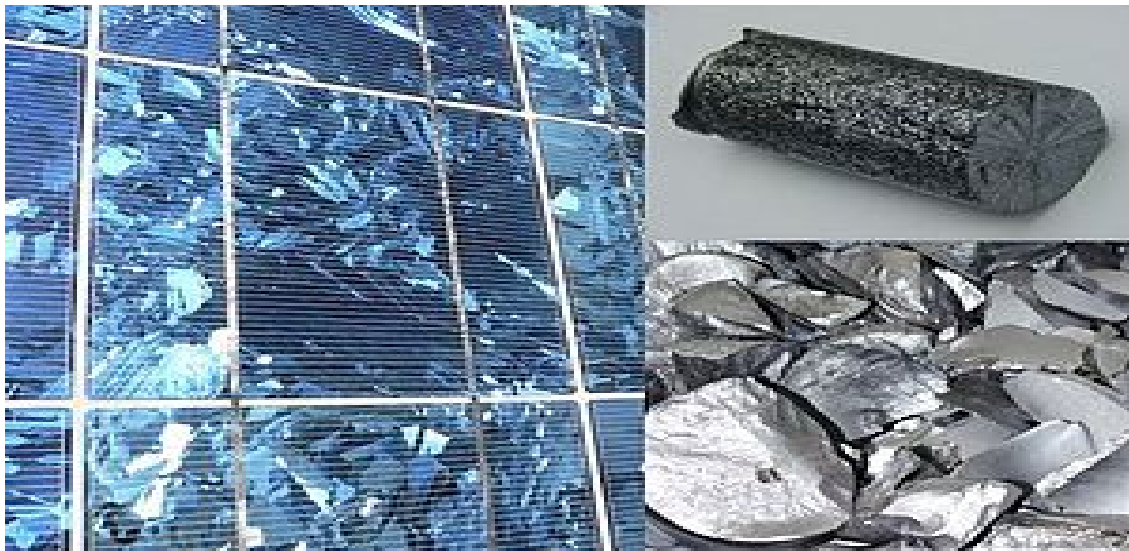
Σχήμα 1.33 Ράβδος πυριτίου προς κατασκευή κρυσταλλικών Φ/Β πυριτίου
