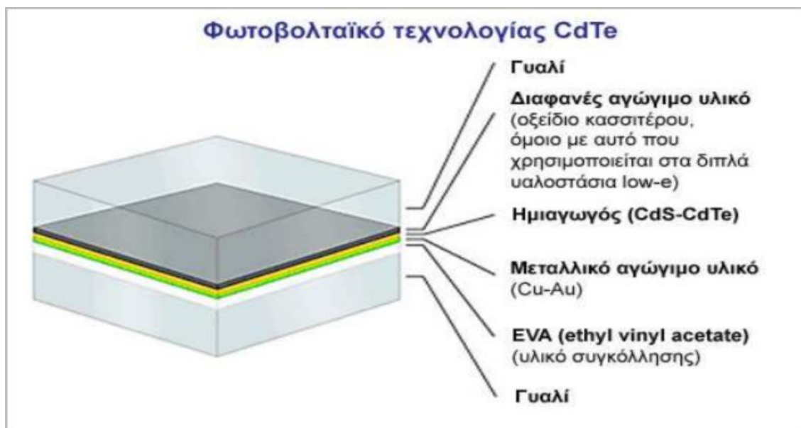
Σχήμα 1.36 Βασικά μέρη που αποτελείται ένα φ/β λεπτού υμενίου τεχνολογίας CdTe 9
