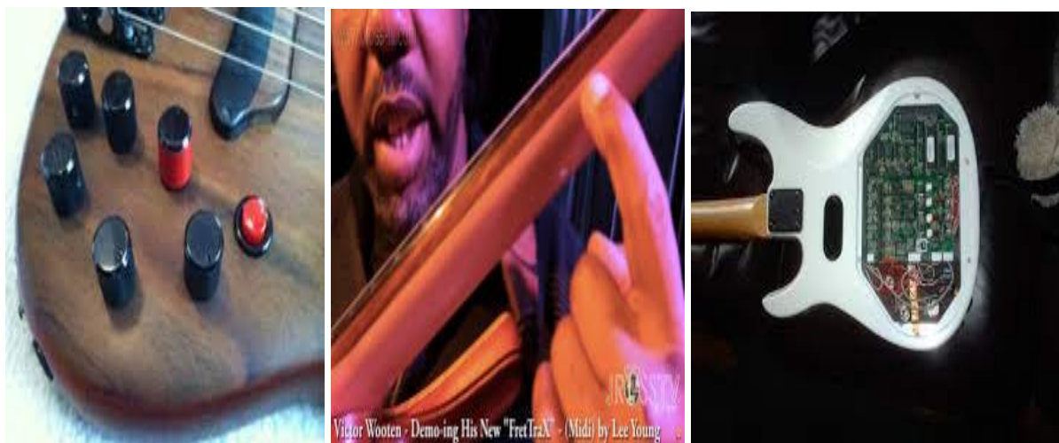
Εικόνα 2: Ποτενσιόμετρα (αριστερά), επιπλέον μέρος ξύλου με ηλεκτρονικά στοιχεία (κέντρο), Πλακέτα (δεξιά)
