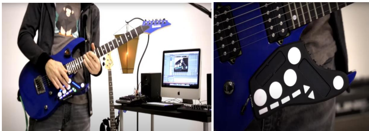
Εικόνα 4: Το livid guitar wing κατά την διάρκεια μιας εκτέλεσης (αριστερά), το livid guitar wing τοποθετημένο (δεξιά)
