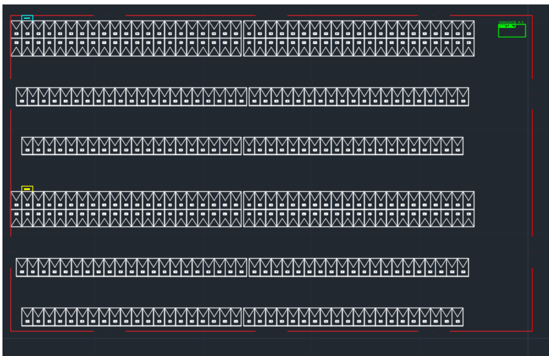
Εικόνα 11: Χωροθέτηση Φ/Β πάρκου εντός ορίων μέσω AutoCAD.
