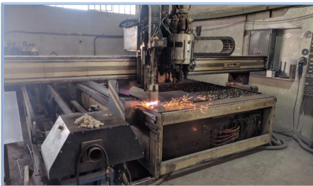
Εικόνα 35. Διαδικασία κοπής ελασμάτων με πλάσμα.
