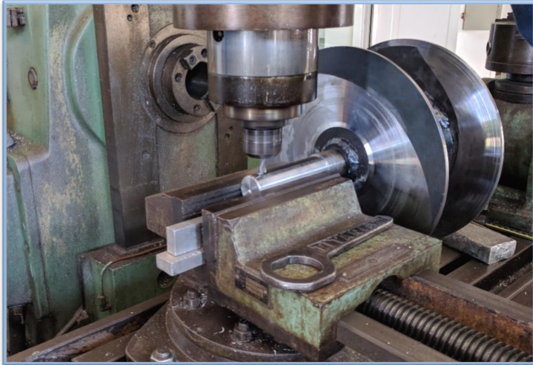
Εικόνα 44. Άνοιγμα σφηναύλακα στον άξονα.
