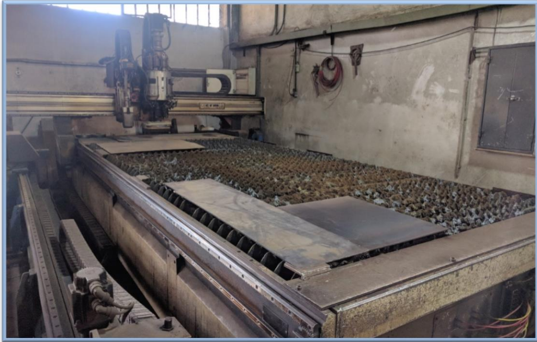
Εικόνα 36. Τοποθέτηση λαμαρινών στο σημείο αναφοράς της εργαλειομηχανής.
