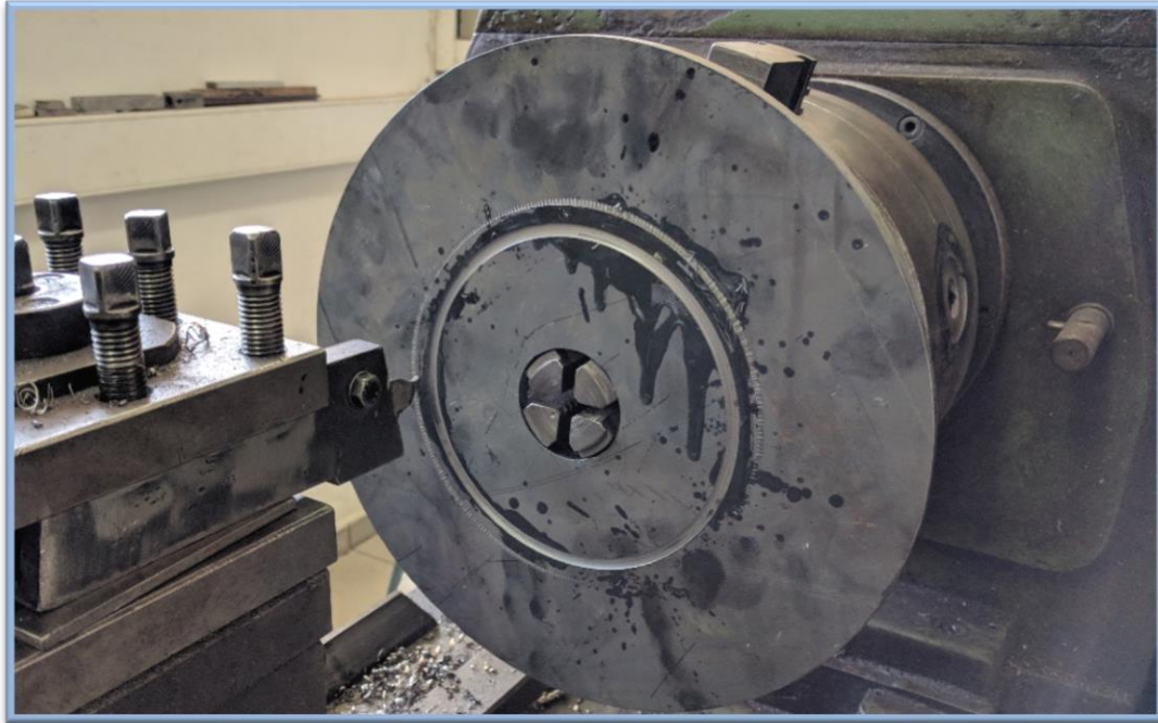
Εικόνα 40. Άνοιγμα αυλακώσεων για τη τοποθέτηση της σωλήνας τυμπάνου.
