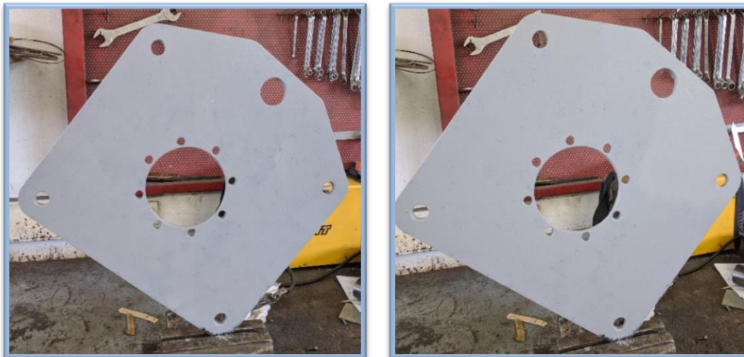
Εικόνα 46. Βαφή πλευρικών ελασμάτων με αστάρι.
