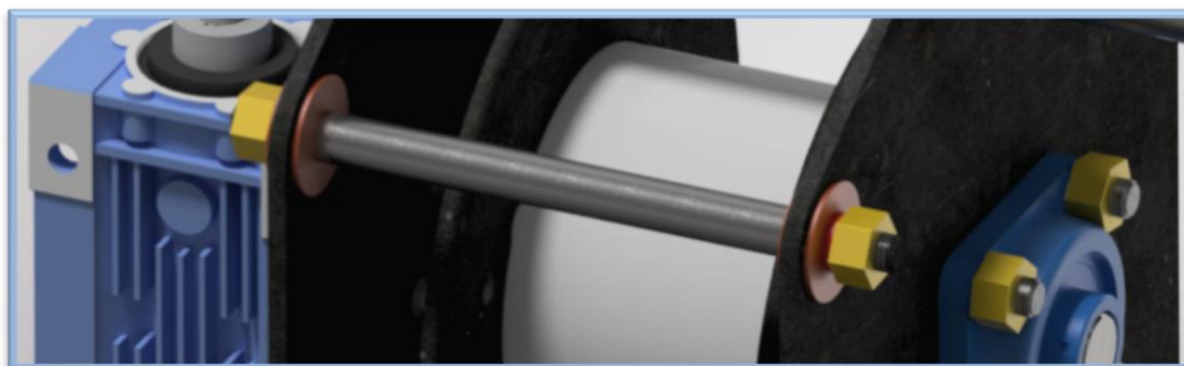
Εικόνα 32. Θέση ντίζας πάνω στη κατασκευή.
