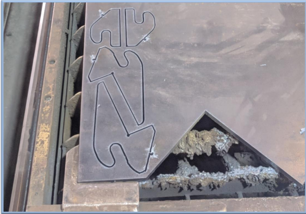
Εικόνα 38. Κοπή βάσεων με πλάσμα σε λαμαρίνα 10mm.
