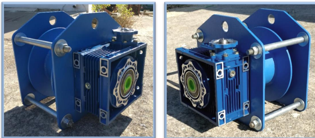
Εικόνα 54. Τελική εικόνα θιντσιού, μετά από πλήρη συναρμολόγηση.
