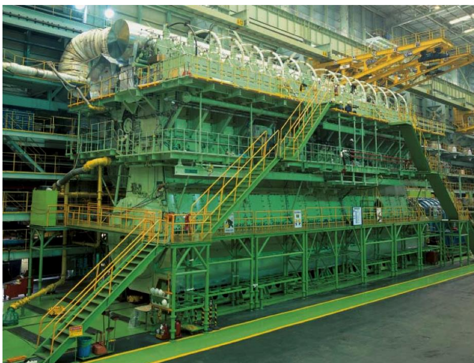
Εικόνα 4: Ο κινητήρας Wärtsilä RT-flex96C με ισχύ 83MW στις 120 [rpm].
