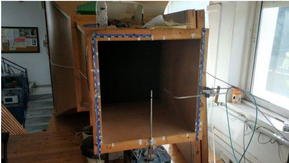
Εικόνα 27. Διάταξη Hotwire, Pitot και Static στην έξοδο της αεροσήραγγας
