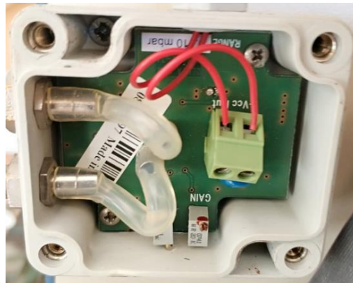
Εικόνα 28. Εσωτερικό διαφορικού αισθητήρα(HD408T) .
