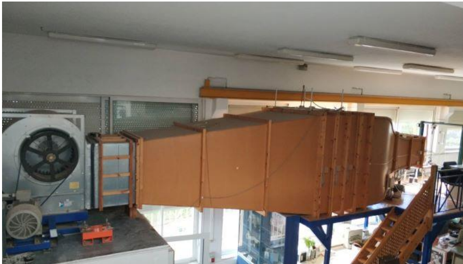
Εικόνα 34. Η αεροσήραγγα του εργαστηρίου
