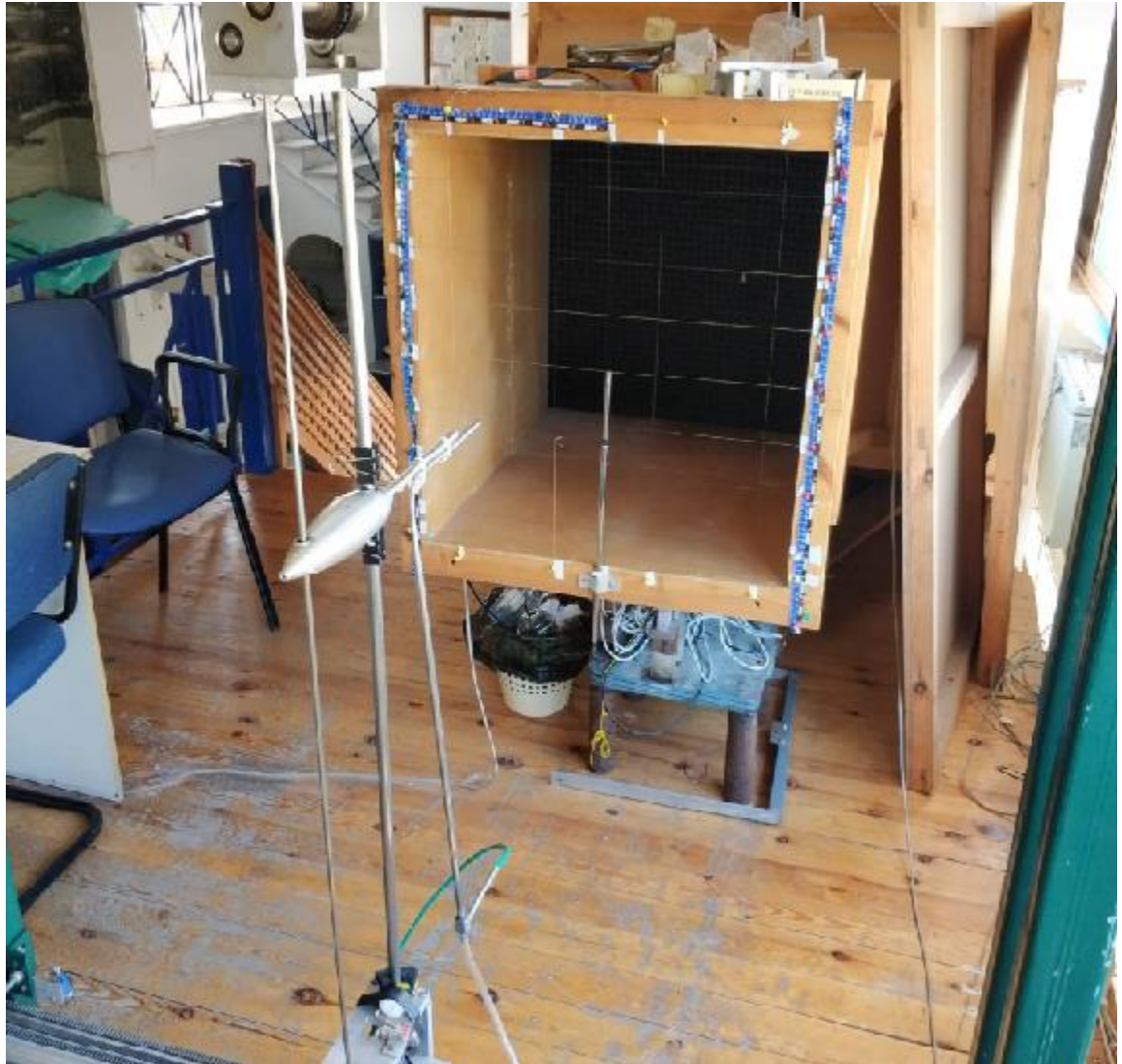
Εικόνα 52. ακροφύσιο αεροσήραγγας μαζί με τα όργανα μέτρησης και τράπεζα XY.
