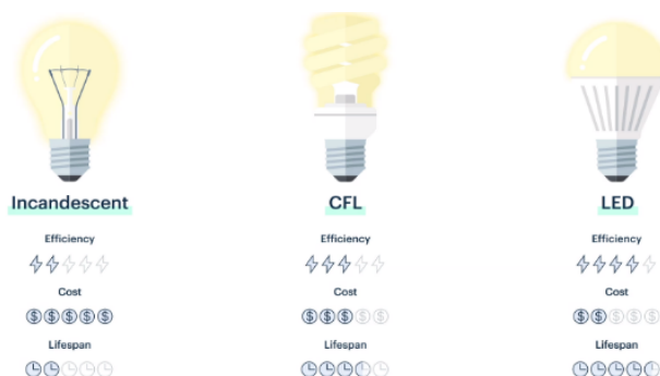
Εικόνα 18 : Αποδόσεις λαμπτήρων πυρακτώσεως , φθορισμού και LED αντίστοιχα
