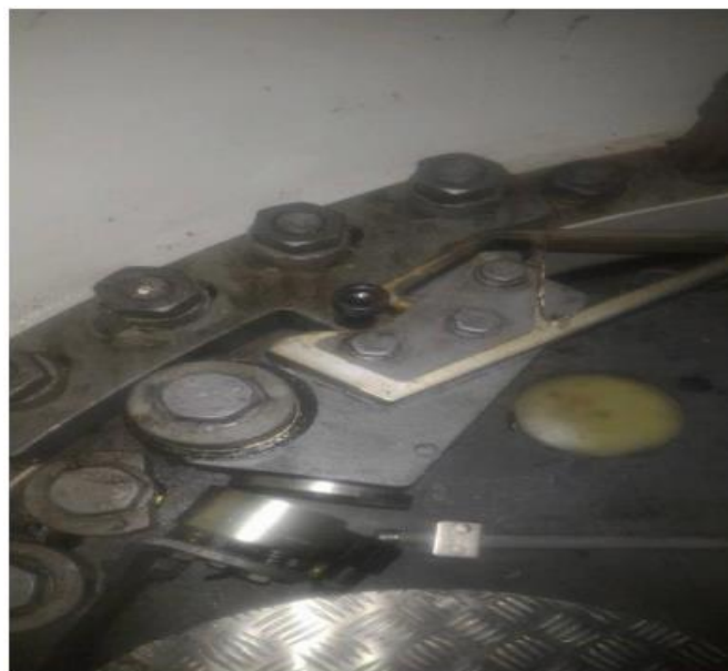
Εικόνα 3.8 Σύστημα ασφάλισης φτερών (Pitch lock).
