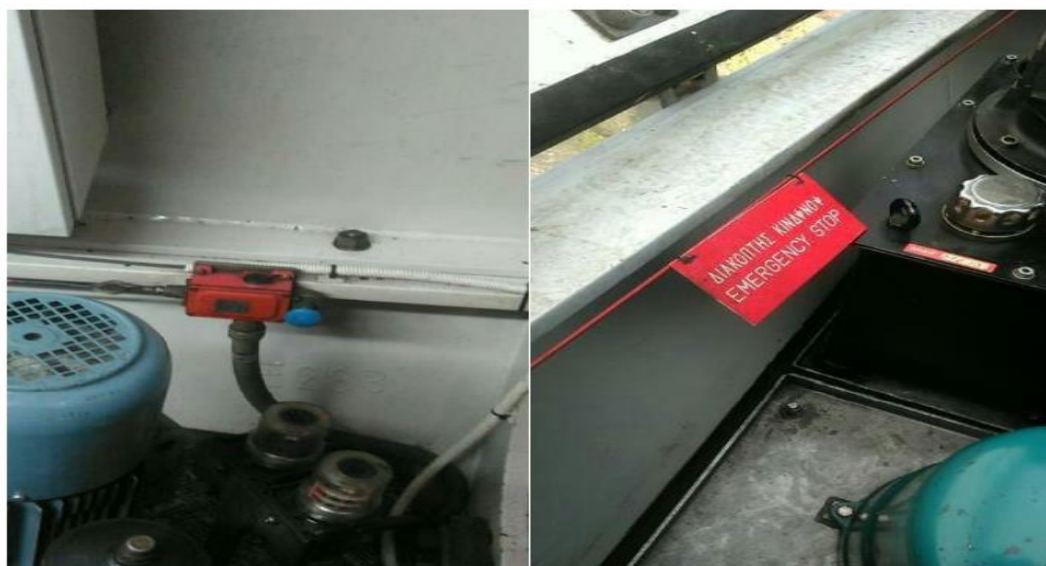
Εικόνα 3. 6 Emergency stop στην άτρακτο της Α/Γ.
