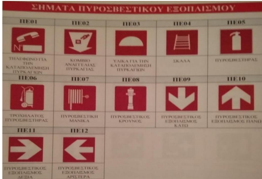
Εικόνα 6.11 Σημάνσεις Πυροσβεστικού υλικού.
