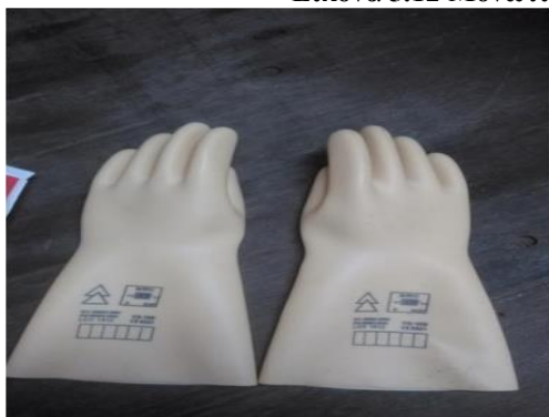
Εικόνα 5.13 Μονωτικά γάντια αντοχής 1000V.
