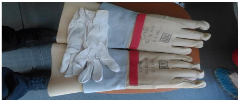
Εικόνα 5.12 Μονωτικά γάντια αντοχής 20KV
