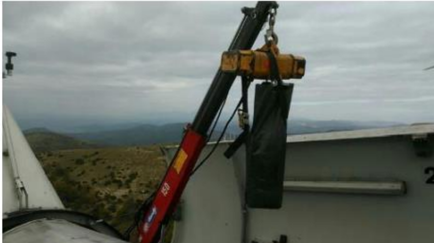
Εικόνα 3.9 Σύστημα ανόδου και καθόδου εργαλείων απο την άτρακτο της Α/Γ στο έδαφος.
