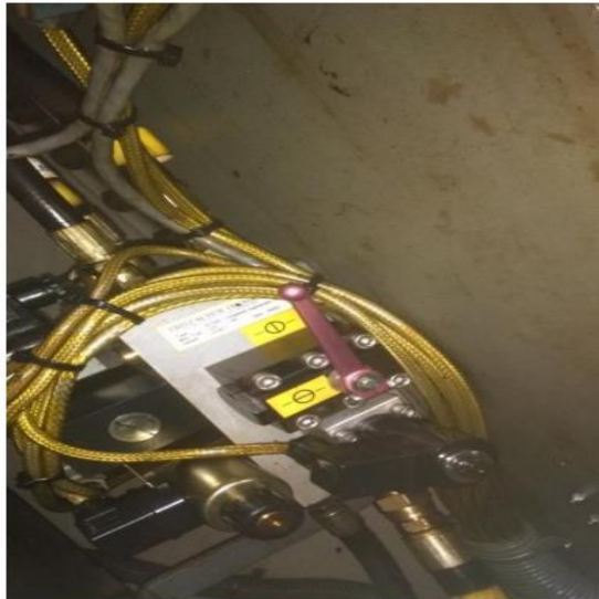
Εικόνα 3.7 Βάνες ασφαλείας των φτερών εντός του Hub.
