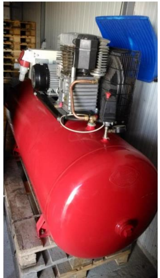
Εικόνα 2.34 Σύστημα πίεσεως αέρος.
