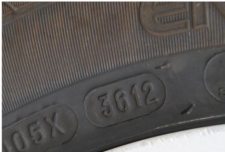
Εικόνα 39: Ημερομηνία κατασκευής του ελαστικού
