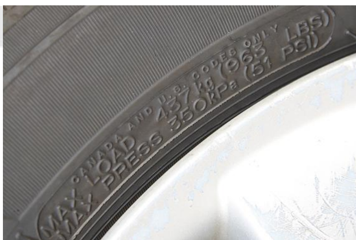
Εικόνα 38: Μέγιστο βάρος και πίεση σε κάθε ελαστικό που συστήνονται από το κατασκευαστή
