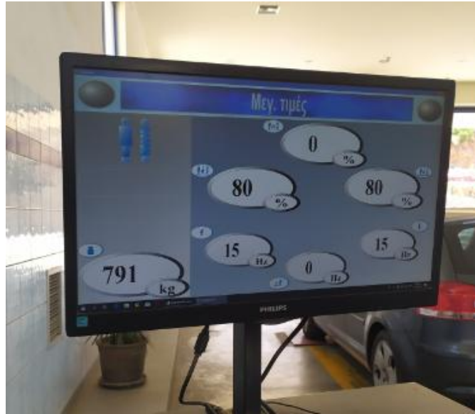
Εικόνα 21: Τέλος, εμφανίζονται τα αποτελέσματα των μετρήσεων του πρώτου άξονα στην οθόνη του Η/Υ. Στην αριστερή πλευρά της οθόνης είναι οι μετρήσεις της ανάρτησης του αριστερού τροχού και αντίστοιχα στη δεξιά πλευρά της οθόνης οι μετρήσεις της ανάρτησης του δεξιού τροχού. Το συγκεκριμένο όχημα, έχει απόδοση για κάθε ανάρτηση 80% και 0% είναι η διαφορά της απόδοσης τους.
