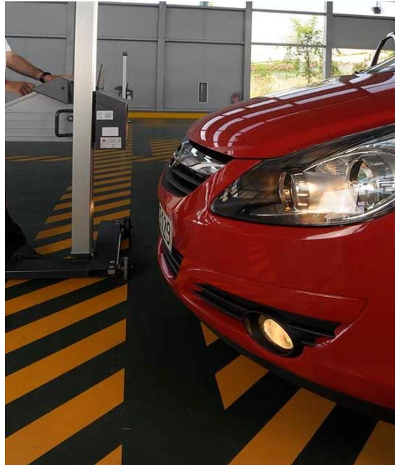
Εικόνα 36: Τρόπος χρήσης του φωτόμετρου
