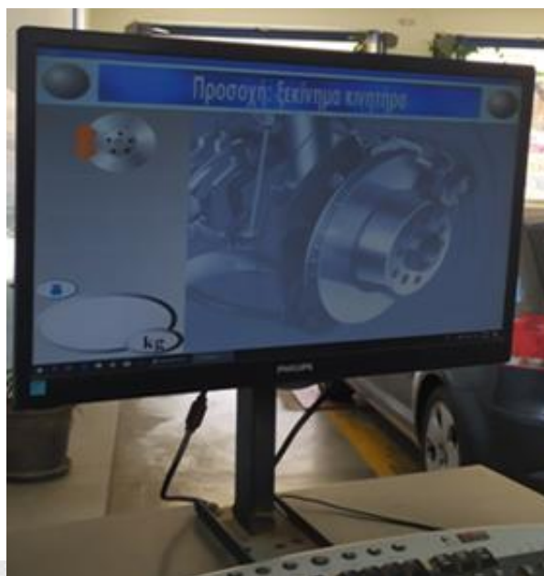
Εικόνα 24: Ξεκίνημα κινητήρα για τον έλεγχο του συστήματος πέδησης στο πρώτο άξονα του οχήματος .
