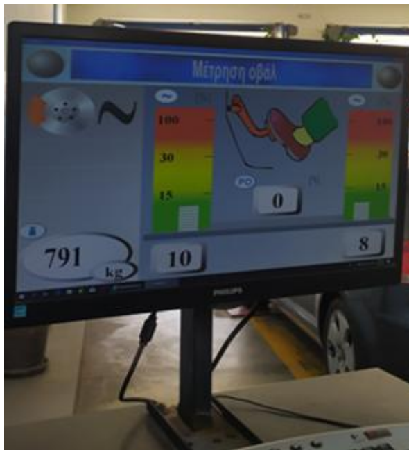
Εικόνα 26: Μόλις δοθεί η εντολή αυτή, το πεντάλ μένει σταθερά πατημένο μέχρι να γίνει η μέτρηση της παραμόρφωσης. Μετά, ο ελεγκτής, τερματίζει το πεντάλ του φρένου και βγαίνουν τα αποτελέσματα.
