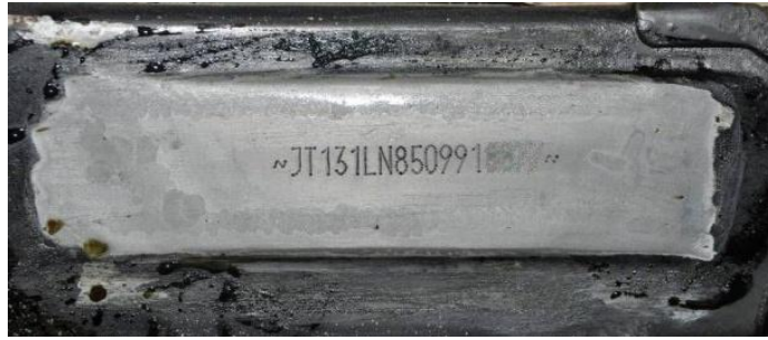
Εικόνα 40: Αριθμός πλαισίου χαραγμένος σε μεταλλικό σημείο του οχήματος
