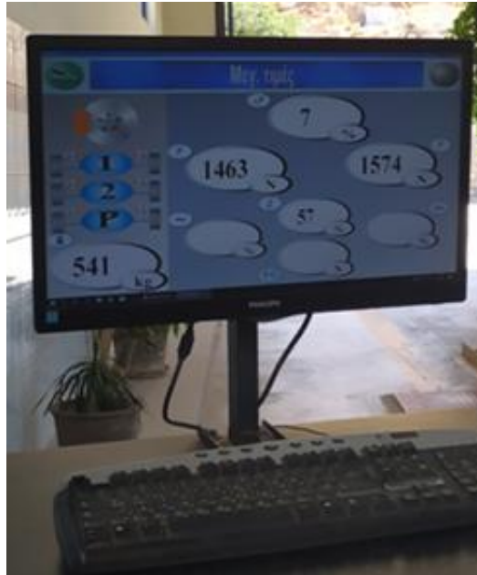
Εικόνα 28: Έπειτα, γίνεται έλεγχος για τη δύναμη πέδησης του χειρόφρενου. Για να επιτευχθεί αυτό, ο ελεγκτής, αυξάνει αργά τη δύναμη στο χειρόφρενο μέχρι τη μεγαλύτερη τιμή του. Η απόδοση του χειρόφρενου είναι 57% και η διαφορά ανά άξονα 7%.
