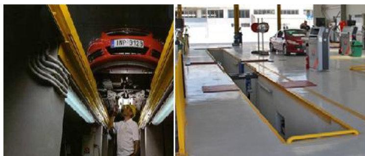
Εικόνα 30: Λάκκος επιθεώρησης (κατόπτρευσης)
