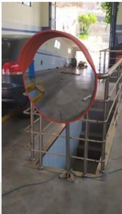
Εικόνα 34: Κάτοπτρο (καθρέπτης) για τον οπτικό έλεγχο των φώτων
