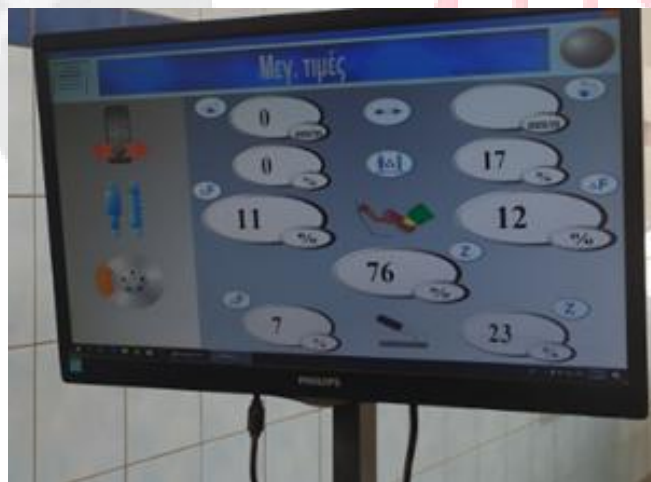
Εικόνα 29: Μετά το πέρας του ελέγχου εμφανίζεται η συνολική απόδοση φρεναρίσματος που είναι 76%.
