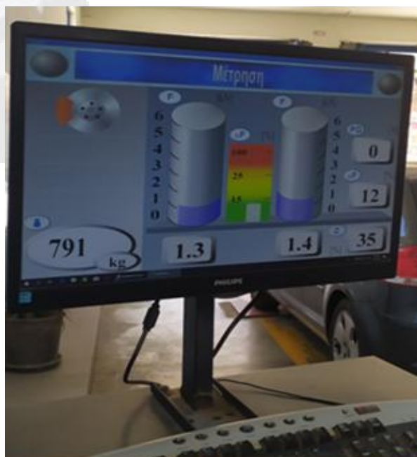
Εικόνα 25: Ο ελεγκτής πατάει όλο κ περισσότερο το πεντάλ του φρένου μέχρι ο Η/Υ να δώσει εντολή ότι μετράει τη παραμόρφωση του δίσκου των φρένων (οβάλ).
