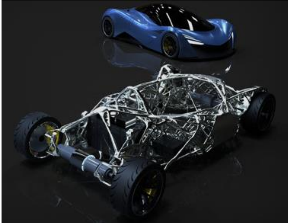
Εικόνα 3.5: Σκελετός concept car χιρσίας με την χρήση τοπολογικής βελτιστοποίησης.[45]
