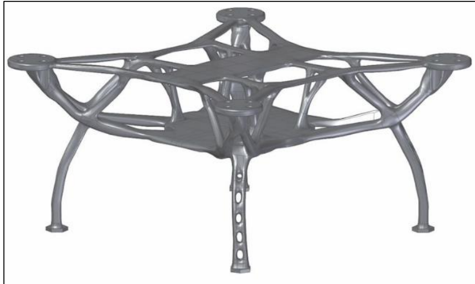
Εικόνα 2.2: Γενετική βελτιστοποίηση σκελετού Drone.[35]
