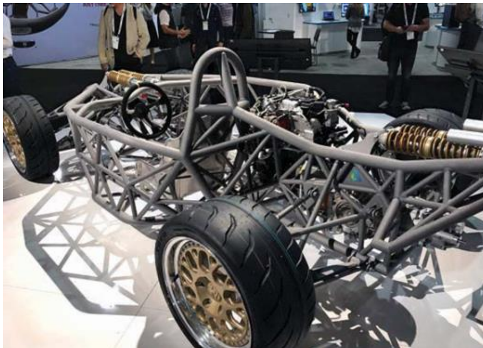
Εικόνα 2.12: Πλαίσιο του La Bandita Speedster μέσω γενετικού σχεδιασμού.[43]
