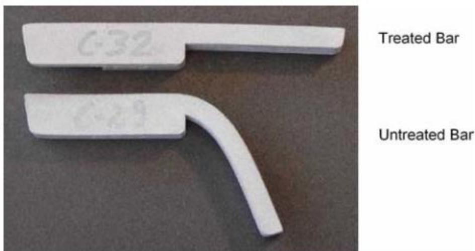
Εικόνα 3.4 Σύγκριση παραμόρφωσης ανοξειδωτου χάλυβα με και χωρίς επεξεργασία νανοσίδηρου [56]
