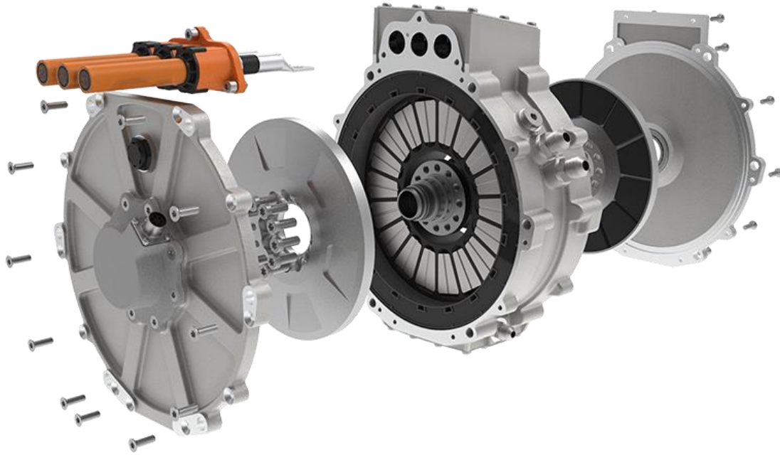
Εικόνα 6.3 : Κινητήρας μονού στάτη-διπλού ρότορα. [44]
