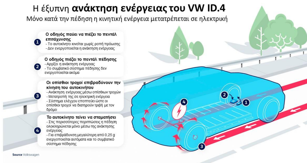
Εικόνα 4.8 : Ο τρόπος λειτουργίας της ανάκτησης ενέργειας του ID.4 του 2021. [31]
