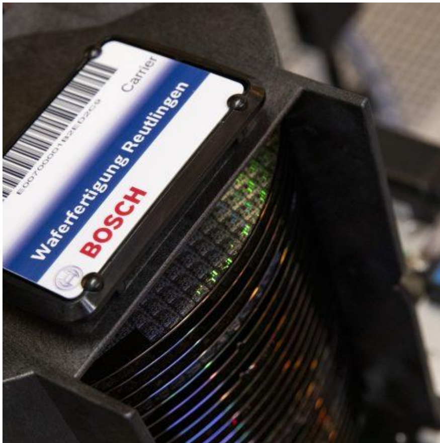
Εικόνα 6.4 : Chips από το υλικό silicon carbide (SiC) από την Bosh. [46]
