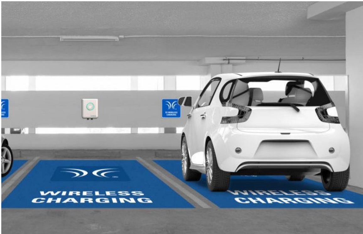
Εικόνα 6.5 : Επαγωγική στατική φόρτιση. [47]
