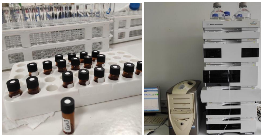
Εικόνα 2.5: Προετοιμασία δειγμάτων και χρήση συστήματος για την ποιοτική και την ποσοτική ανάλυση πολυαμινών σε HPLC
