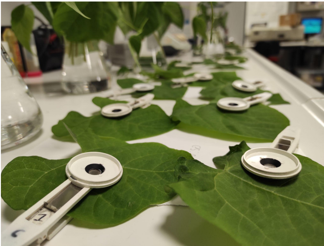
Εικόνα 2.4: Φύλλα P. vulgaris κατά τη διάρκεια της προετοιμασίας τους για καταγραφή του επαγωγικού φθορισμού με την συσκευή Plant Efficiency Analyser (PEA)
