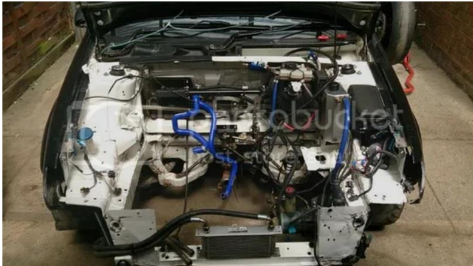
Εικόνα 2: Χώρος Κινητήρα Μετά Την Εξαγωγή Του ΜΕΚ
