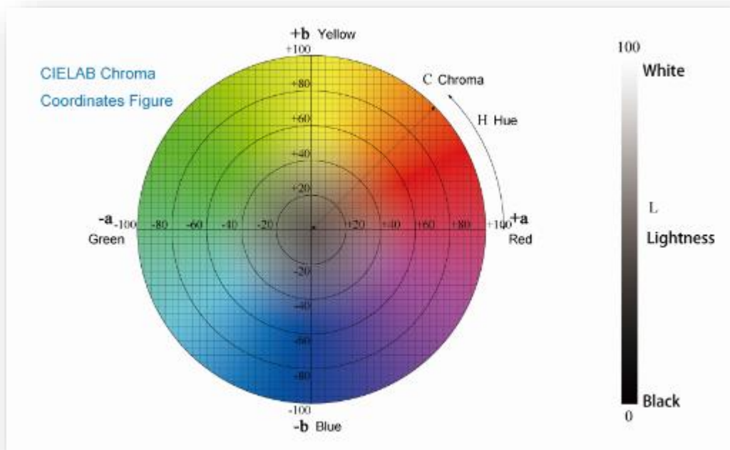
Εικόνα 2.4: Διάταξη των χρωματικών συντεταγμένων L*, a*, b* με βάση το σύστημα του CieLab ( https://www.google.gr/imghp?hl=el&tab=ri&ogbl )
