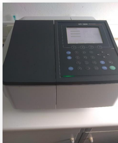
Εικόνα 2.7: Φασματοφωτόμετρο απορρόφησης UV-Vis Shimadzu UV-1800. (εργαστήριο παραγωγής γεωργικών προϊόντων και πολλαπλασιαστικού υλικού ΕΛΜΕΠΑ τμήμα Γεωπονίας)
