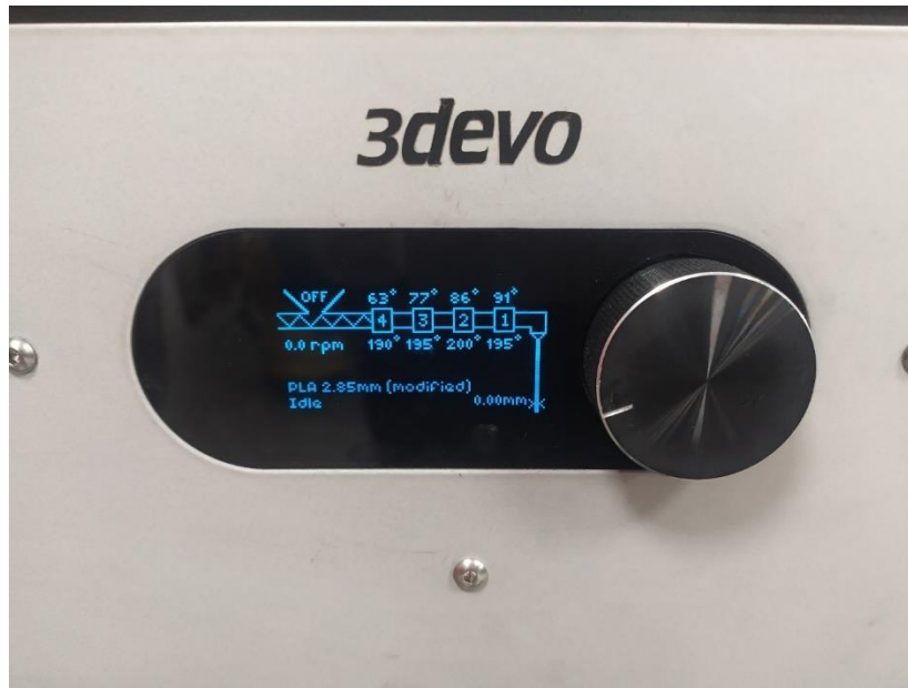
Εικόνα 16: Οι τέσσερις ζώνες θέρμανσης
