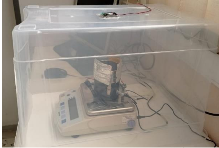
Εικόνα 2: Το όργανο Hyprop με τις τροποποιήσεις από Daliakoroulos et al. 2021a
