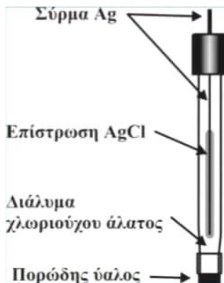
Εικόνα 2.2: Ηλεκτρόδιο αναφοράς τύπου Ag/AgCl 4 .
