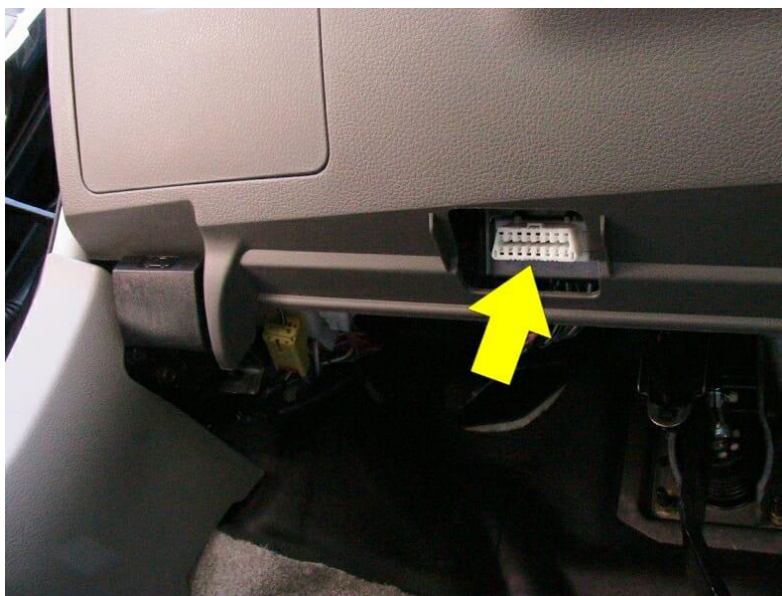
Εικόνα 22: Η θύρα OBDII (DLC) στην καμπίνα οχήματος
