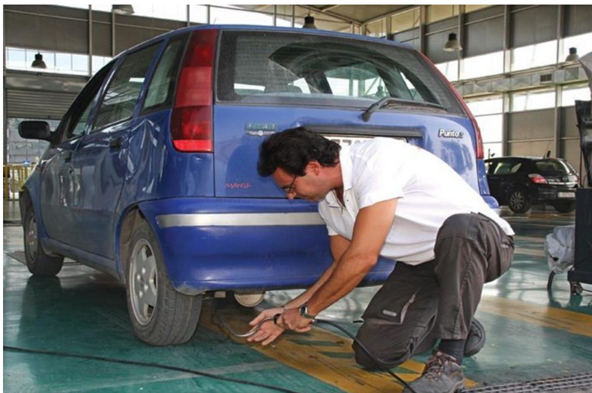
Εικόνα 1. Λήψη καυσαερίων από βενζινοκίνητο όχημα
