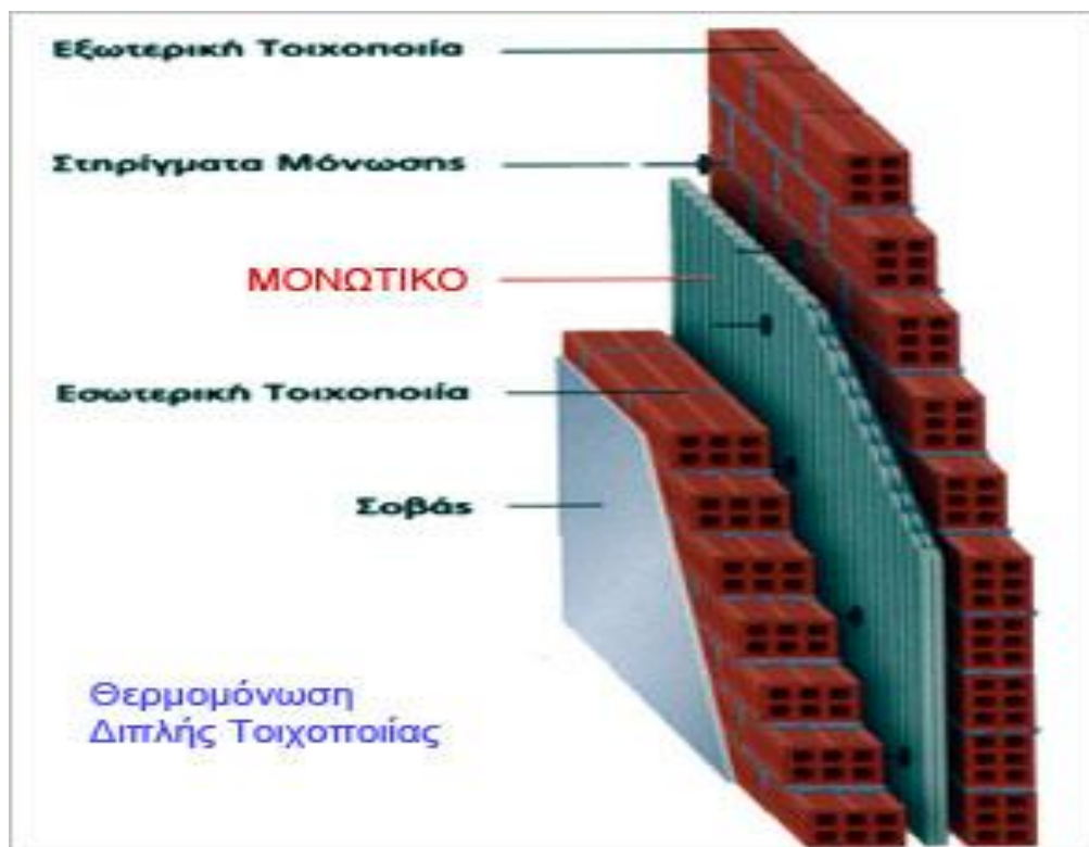
Εικόνα 8 Σχηματική απεικόνιση θερμομόνωσης διπλής τοιχοποιίας
