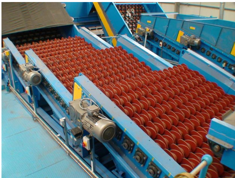
Εικόνα 5.7 Ειδικά διαμορφωμένο μηχανήμα με δίσκους, διαχωρισμού υλικών κατά βάρος.
