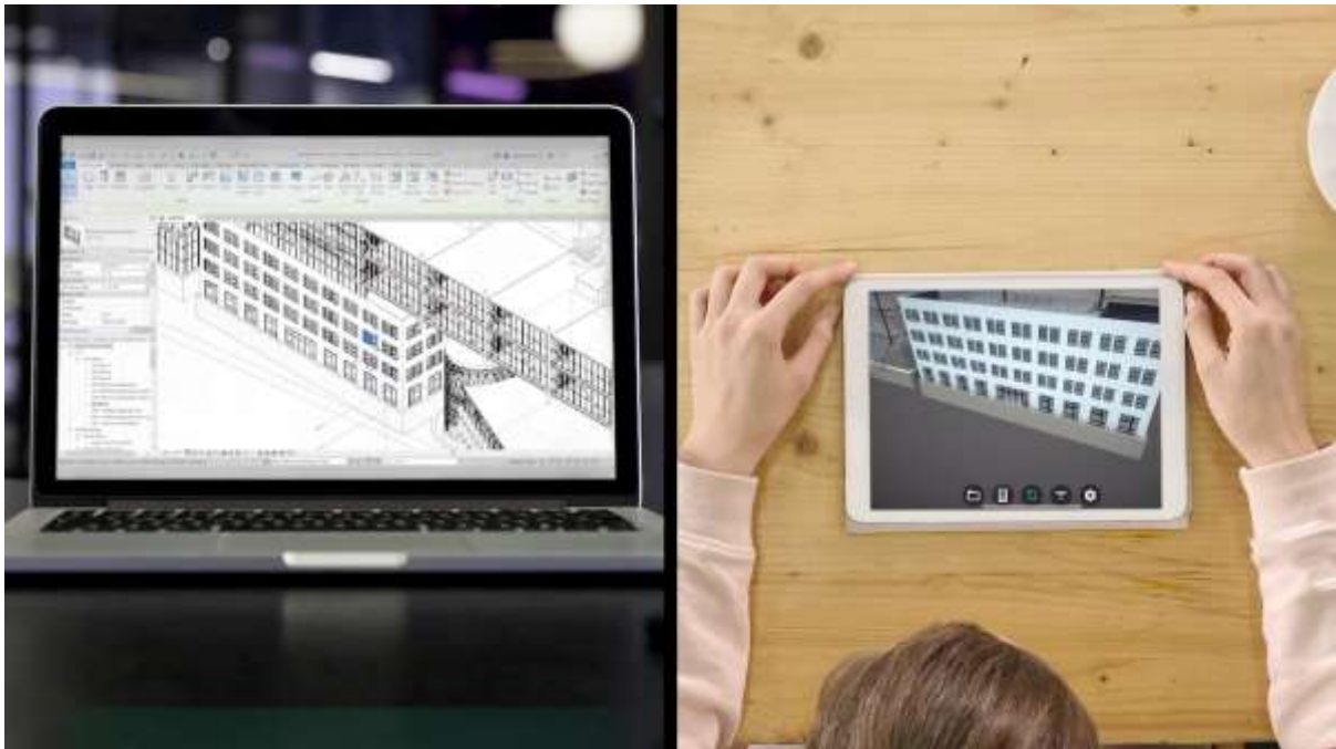
Εικόνα 2 - Απεικόνιση του Revit μοντέλου στον υπολογιστή και αντίστοιχα η απεικόνισή του στην Unity Reflect στο tablet
