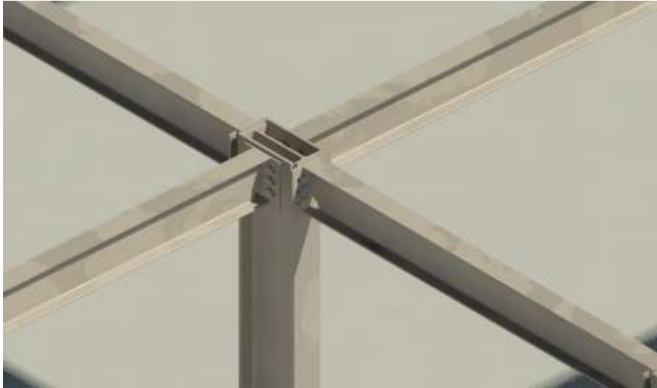
Εικόνα 9 - Στο Revit μεταλλικοί δοκοί με συνδέσμους στον λέβητα (Rendering)
