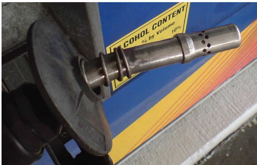
Εικόνα 14 Επιστόμιο με δυνατότητα ανάκτησης ατμών Φάσης II(Stage II)[ google.com/vapor-recovery-hose ]
