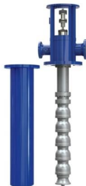
ΕΙΚΟΝΑ 5.21 : Η φυγοκεντρική αντλία τύπου vertically suspended VS6 διπλής αναρρόφησης για χρήση σε διυλιστήριο πετρελαίου. (Ο άξονας της αντλίας εισάγεται μέσα στο μπλέ σωλήνα). ( https://www.ruhrpumpen.com/en/products/vertical-pumps/vlt-pump )
