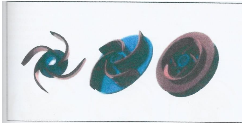
ΕΙΚΟΝΑ 4.9 : Βασικοί τύποι πτερωτών (αριστερά:ανοικτού τύπου, κέντρο:ημίκλειστου τύπου, δεξιά:κλειστού τύπου)
