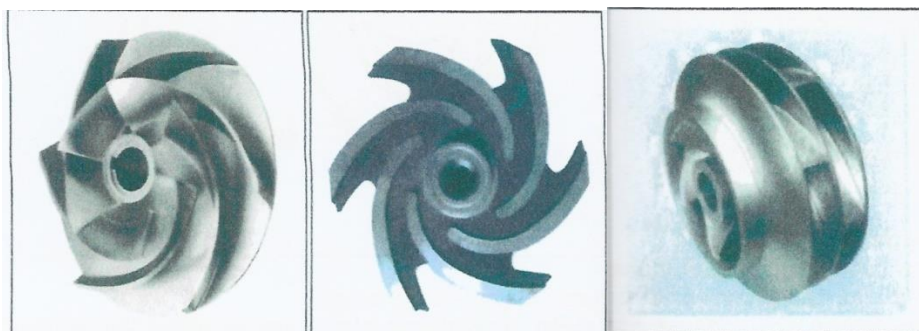
ΕΙΚΟΝΑ 4.10 : Βασικοί τύποι πτερωτών άλλης μορφολογίας (αριστερά:ημίκλειστου τύπου, κέντρο:ανοικτού τύπου, δεξιά:κλειστού τύπου)
