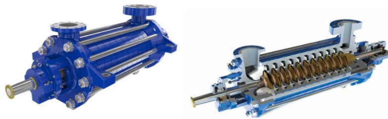
ΕΙΚΟΝΑ 5.12: Η φυγοκεντρική αντλία τύπου between-bearings BB4 για χρήση σε διυλιστήριο πετρελαίου μαζί με μερική τομή της https://www.ruhrpumpen.com/en/products/between-bearing-pumps/gp-pump
