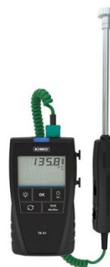
ΕΙΚΟΝΑ 3.6 : Θερμόμετρο με υποδοχές για θερμοζεύγη τύπου K, J, T & S
