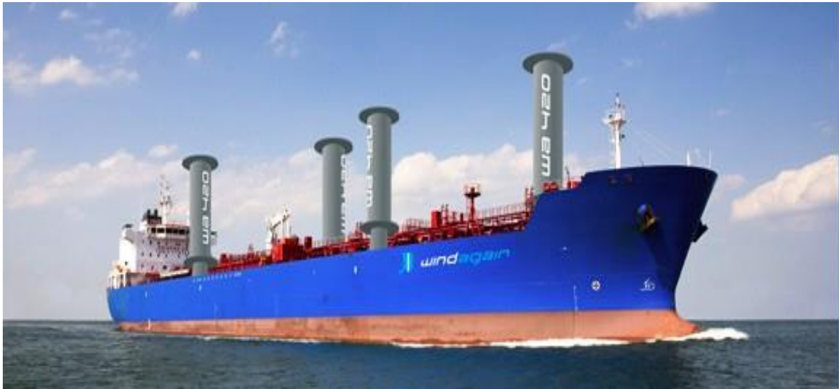
Εικόνα 6.11: Πλοίο κινούμενο με τεχνολογία Magnus / Flettner Rottor (πηγή: maritimocyprus.com)
