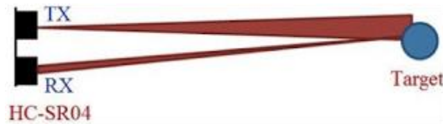
Σχήμα 20: Αρχή λειτουργίας Ultrasonic Sensor
