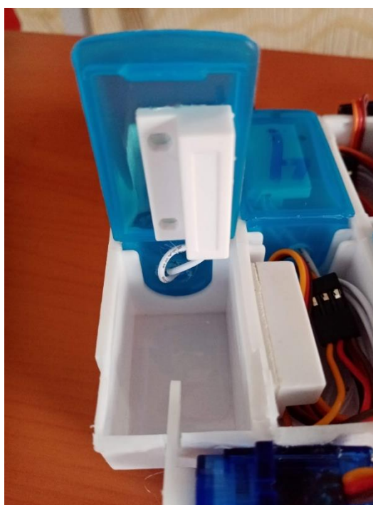
Σχήμα 32: Pill box με αισθητήρες μαγνητικούς και micro servo κινητήρα
