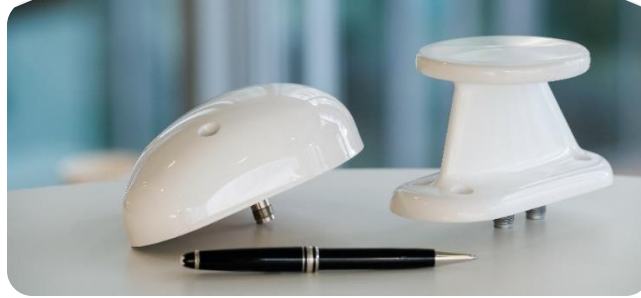
Εικόνα 4.5 Δεξιά: Η LTE κεραία (δεξιά) του σταθμού αεροσκάφους για το επίγειο δίκτυο EAN ACGC (Aviation Complementary Ground Component), Αριστερά: Η δορυφορική κεραία του αεροσκάφους για το EAN Mobile Satellite Services (MSS) S-band [91]
