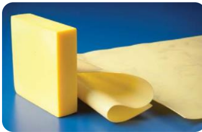
Εικόνα 4.24 Διάφοροι τύποι polyimide aerogel που ανέπτυξε το εργαστήριο της NASA [142]
