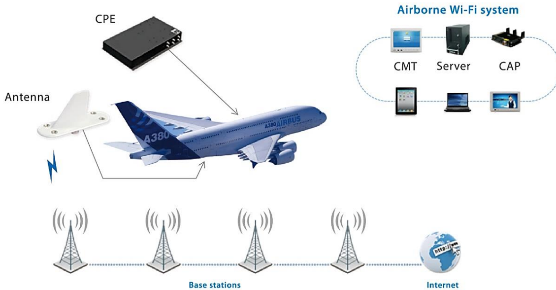
Εικόνα 4.22 Το σύστημα 5G ATG της ZTE [81]
