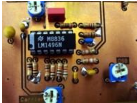
Εικόνα 4.4. Ο ισοσταθμισμένος διαμορφωτής βασίζεται στο γνωστό MC1496, το οποίο είναι σε θέση να καταστείλει την υποφέρουσα περισσότερο από 60db.
