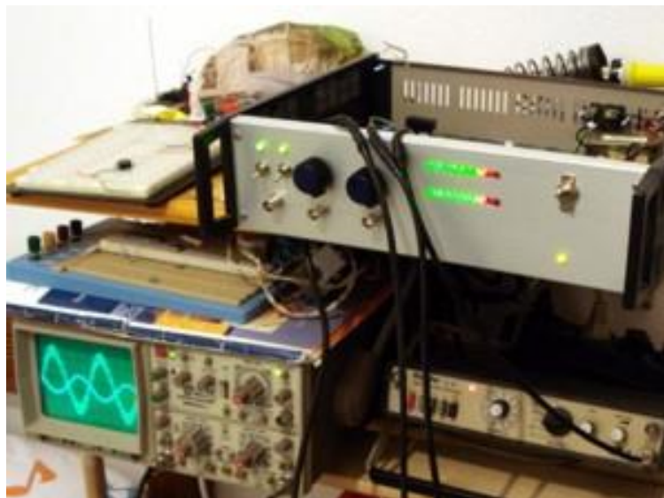
Εικόνα 4.7. Ο κωδικοποιητής FM Stereo σε λειτουργία (διακρίνεται η μονάδα VU-meter).
