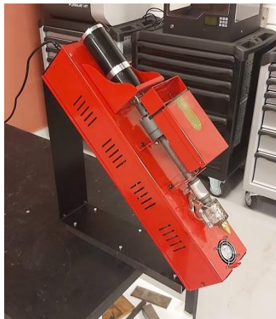
Εικόνα 8.4: Απεικόνιση εργαστηριακού εξωθητή νημάτων Noztek Pro.
