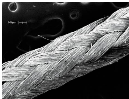
Εικόνα 7.1: Μικροσκοπική όψη ενός πλεγμένου ράμματος μεταξιού από το Τμήμα Επιστήμης Ινών και Σχεδιασμού Ενδυμάτων και Βιοϊατρικής Μηχανικής, Πανεπιστήμιο Cornell, Ithaca, NY.
