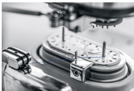
Εικόνα 4.7: Απεικόνιση διαδικασίας περιέλιξης του ράμματος σε δίσκο με έως και 800 περιστροφές ανά λεπτό.
