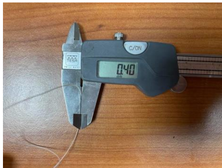
Εικόνα 9.4: Απεικόνιση μέτρησης διαμέτρου ίνας ράμματος PP/TiO 2 0.5%/ Antibacterial Nanopowder 2.0%, με χρήση ψηφιακού παχυμέτρου.
