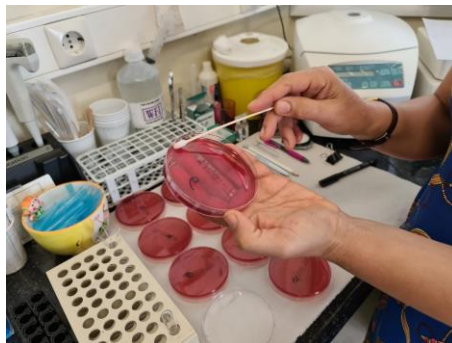
Εικόνα 9.7: Απεικόνιση διαδικασίας ενοφθαλμισμού τρυβλίων με βακτηριακό διάλυμα.
