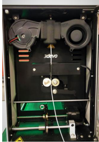
Εικόνα 9.2: Απεικόνιση διαδικασίας εξώθησης νημάτων PP/Antibacterial Nanopowder 2.00% σταθερής διαμέτρου 1,75mm, κατάλληλο για χρήση σε 3D εκτύπωση τεχνολογίας FFF, με χρήση εξωθητή νημάτων μονής βίδας 3D Eno Composer 450.
