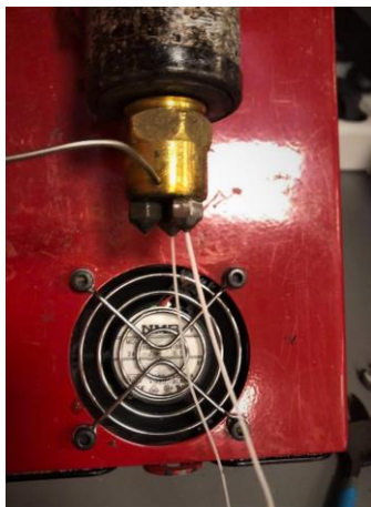
Εικόνα 9.1: Απεικόνιση διαδικασίας εξώθησης ινών ράμματος καθαρού Πολυπροπυλενίου (PP) διαμέτρων 0.2mm, 0.4mm και 0.6mm, με χρήση εξωθητή νημάτων Noztek Pro με προσαρμοσμένο εξάρτημα τριών ακροφύσιων.
