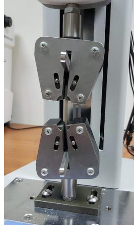
Εικόνα 9.5: Απεικόνιση διαδικασίας δοκιμής για αντοχή σε εφελκυσμό σε δοκίμιο εφελκυσμού κατασκευασμένο από PP/ TiO 2 0.5%/ Antibacterial Nanopowder 2.0%, με χρήση συσκευής Imada MX2 (Imada Inc., Northbrook, IL, USA).
