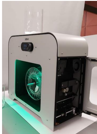
Εικόνα 8.5: Απεικόνιση εργαστηριακού εξωθητή νημάτων 3D Evo Composer 450.
