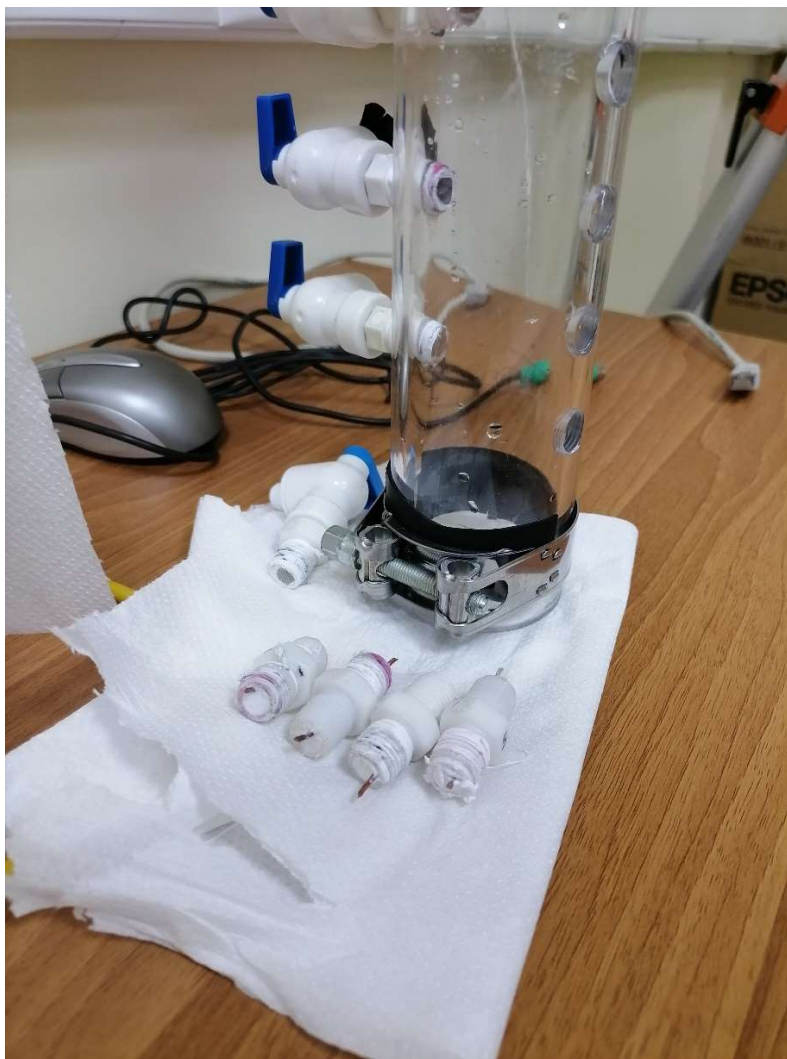
Εικόνα 3.13: Πλαστική στήλη με τοποθετημένα βρυσάκια για τον έλεγχο του επιπέδου των υγρών εντός, τα ηλεκτρόδια δεν έχουν τοποθετηθεί ακόμα.
