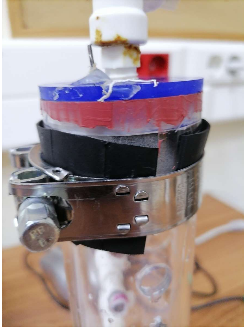
Εικόνα 3.14: Πώμα στήλης μετρήσεων το οποίο διαπερνάτε από ηλεκτρόδιο και έχει βρυσάκι για την εκτόνωση του νερού και του αέρα εντός της στήλης. Η λευκή γραμμή που φαίνεται στο εσωτερικό του σωλήνα είναι το τεφλόν το οποίο χρησιμοποιήθηκε για την στεγανοποίηση του πώματος.
