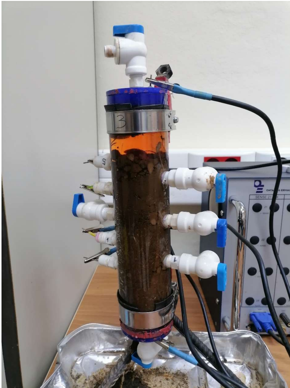
Εικόνα 4.90: Δείγμα εδάφους με πετρέλαιο μετά την ολοκλήρωση των οκτώρων μετρήσεων. Η στήλη είναι συνδεδεμένη με το PSIP Unit.
