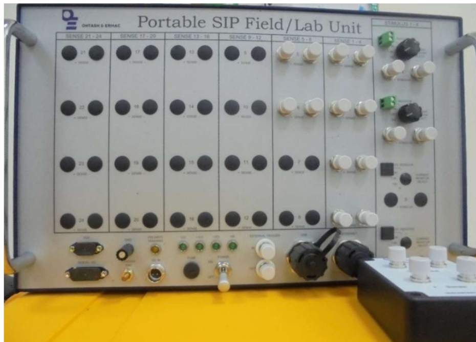
Εικόνα 3.2: Portable SIP (Spectral Induced Polarization) Field / Lab Unit της εταιρίας Ontash & Ermac.
