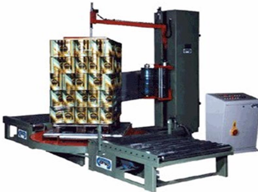
Εικόνα 7. Περιτύλιξη παλετών ,(www.constrinox.gr ,2005).
