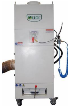
Εικόνα 11. μονάδα συλλογής του αέρα, εξοπλισμένη με ειδικά φίλτρα
