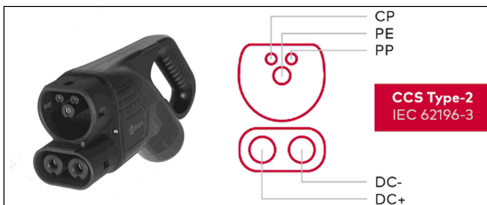
Εικόνα 5.9: Βύσμα τύπου CCS2 και διάταξη ακροδεκτών [10] ΠΗΓΗ: VECTOR
