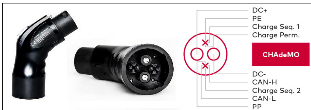
Εικόνα 5.7: Βύσμα CHAdeMO και διάταξη ακροδεκτών [10] ΠΗΓΗ: VECTOR
