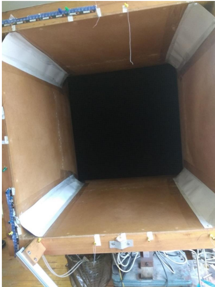
Εικόνα 49:Ενδεικτική τοποθέτηση γωνιών για την δημιουργία εξαγωνικής διατομής.
