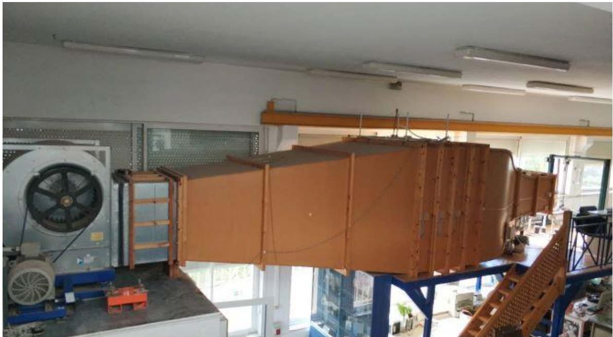
Εικόνα 17: Η αεροσήραγγα του εργαστηρίου.
