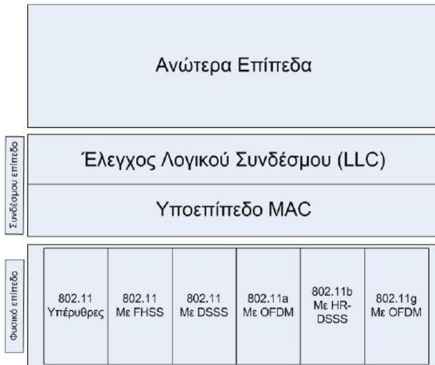
Εικόνα 3.3 Διαστρωμάτωση του 802.11 (Εμφαση στο φυσικό επίπεδο)
