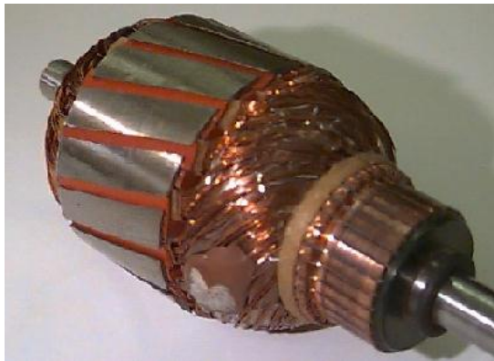
Εικόνα 2.9: Ρότορας με τυλίγμα συνεχούς ρεύματος
