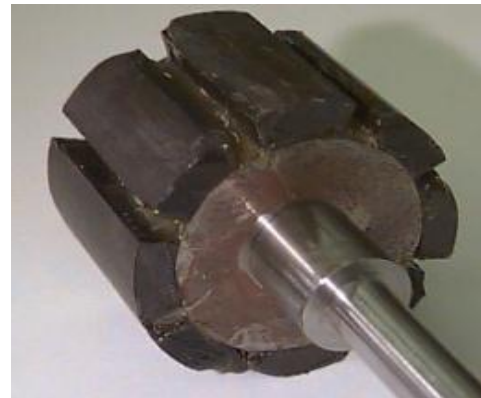
Εικόνα 2.10: Ρότορας με μόνιμους μαγνήτες
