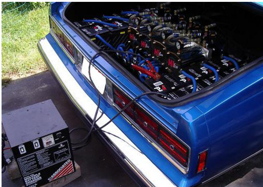
ΕΙΚΟΝΑ 14: ΦΟΡΤΙΣΗ ΜΠΑΤΑΡΙΩΝ ΣΕ ΗΛΕΚΤΡΙΚΟ ΟΧΗΜΑ.
