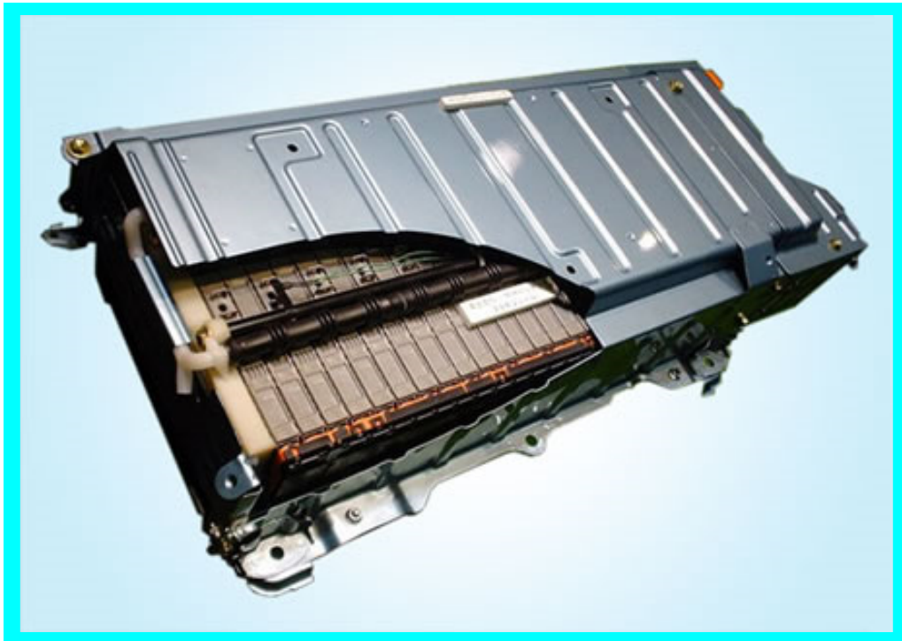
ΕΙΚΟΝΑ 3: ΜΠΑΤΑΡΙΑ ΛΙΘΙΟΥ ΕΙΔΙΚΑ ΣΧΕΔΙΑΣΜΕΝΗ ΓΙΑ ΧΡΗΣΗ ΣΕ ΥΒΡΙΔΙΚΟ ΟΧΗΜΑ.
