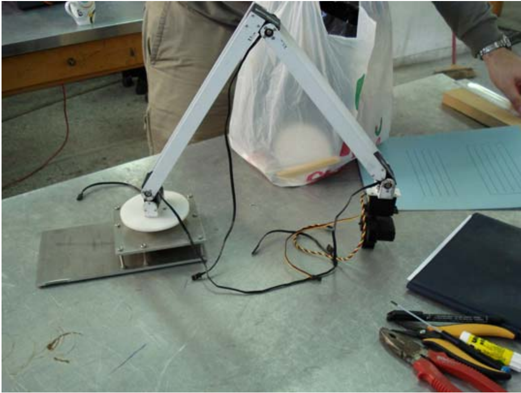
Εικόνα 4.4.1: Πρώτη εκδοχή του ρομποτικού βραχίονα με 5 βαθμούς ελευθερίας.
