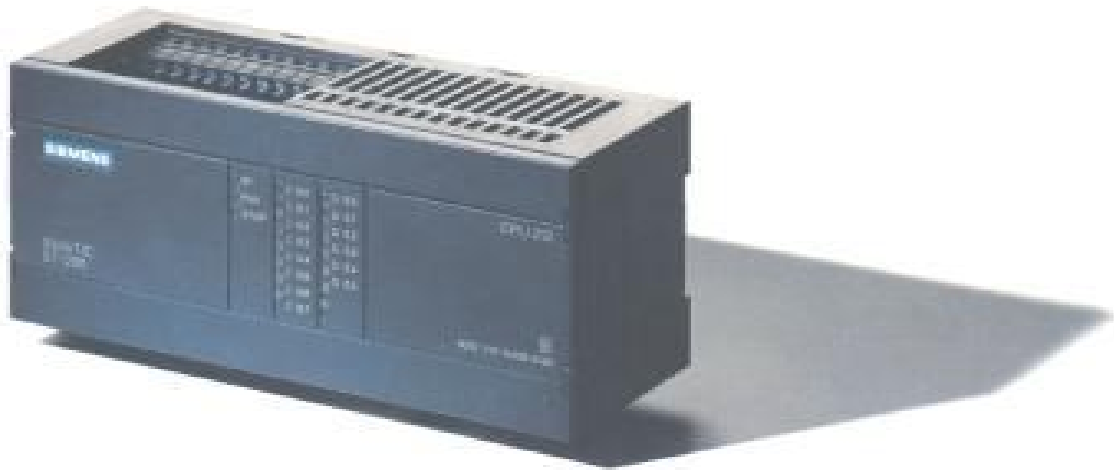
Σχήμα 2.7: Compact PLC. Περιλαμβάνει τροφοδοτικό, κεντρική μονάδα επεξεργασίας, εισόδους και εξόδους, όλα ενσωματωμένα σε μια ενιαία συσκευή.
