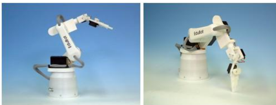
Σχήμα 2.3 Εκπαιδευτικός ρομποτικός βραχίονας “EduBot 100 GP”
