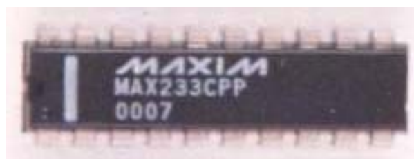
Εικόνα 2.3: Ο RS-232 Driver/Receiver MAX233
