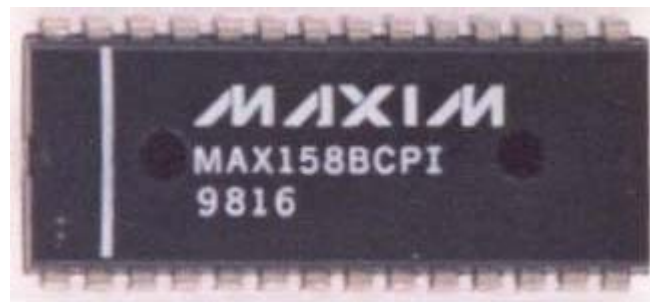
Εικόνα 2.2: Ο μετατροπέας από αναλογικό σε ψηφιακό MAX158
