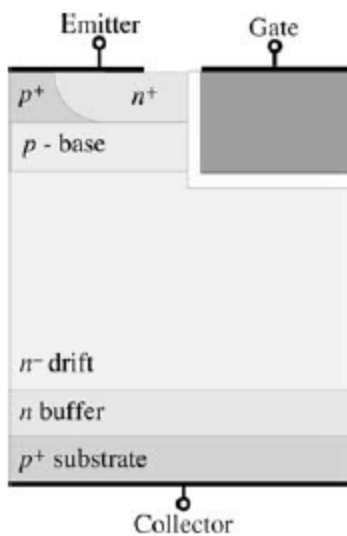
Εικ. 7.7 δομή TRENCH IGBT
