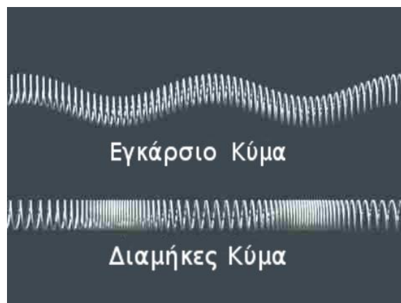
Σχήμα1.17: Εγκάρσιο και διαμήκες ακουστικό κύμα
