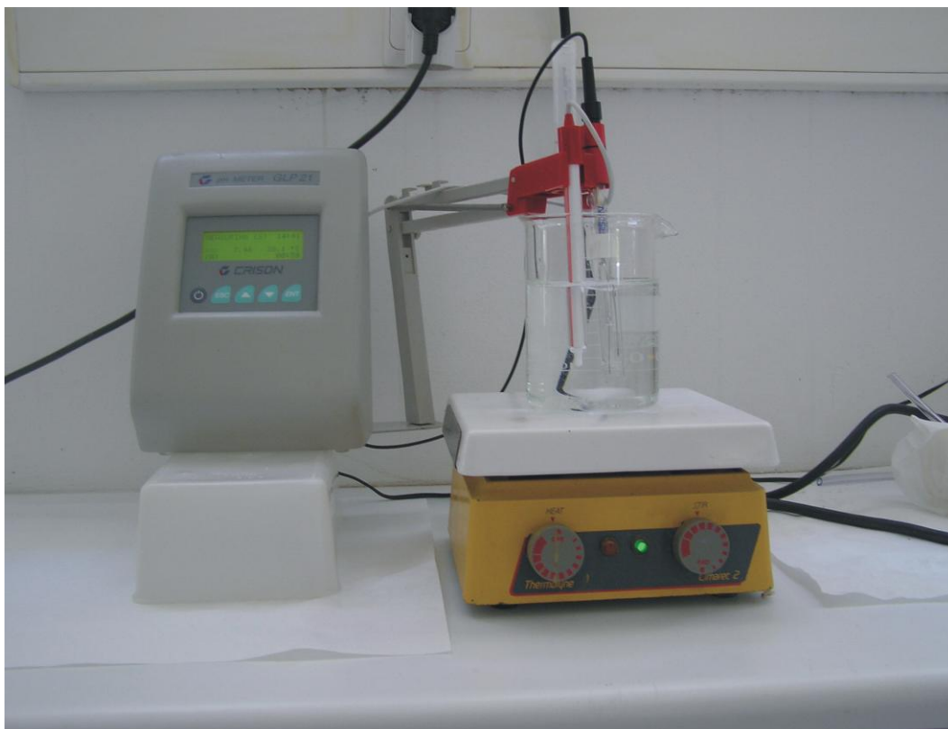
Εικόνα 5 : Διόρθωση- ρύθμιση pH των διαλυμάτων.
