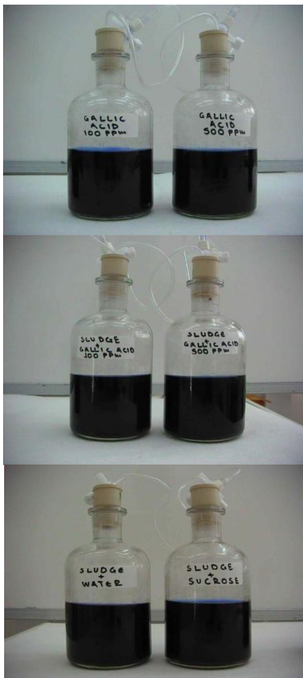
Εικόνα 6: Δείγματα μόλις πριν εγκατασταθούν στο θεرمόλουτρο.
