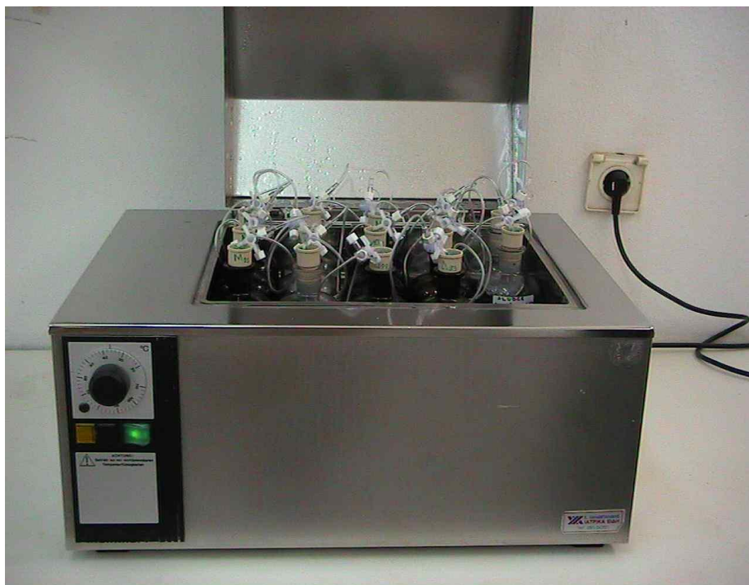
Εικόνα 8 : Εγκατάσταση των δειγμάτων στο θερμόλουτρο (waterbath).
