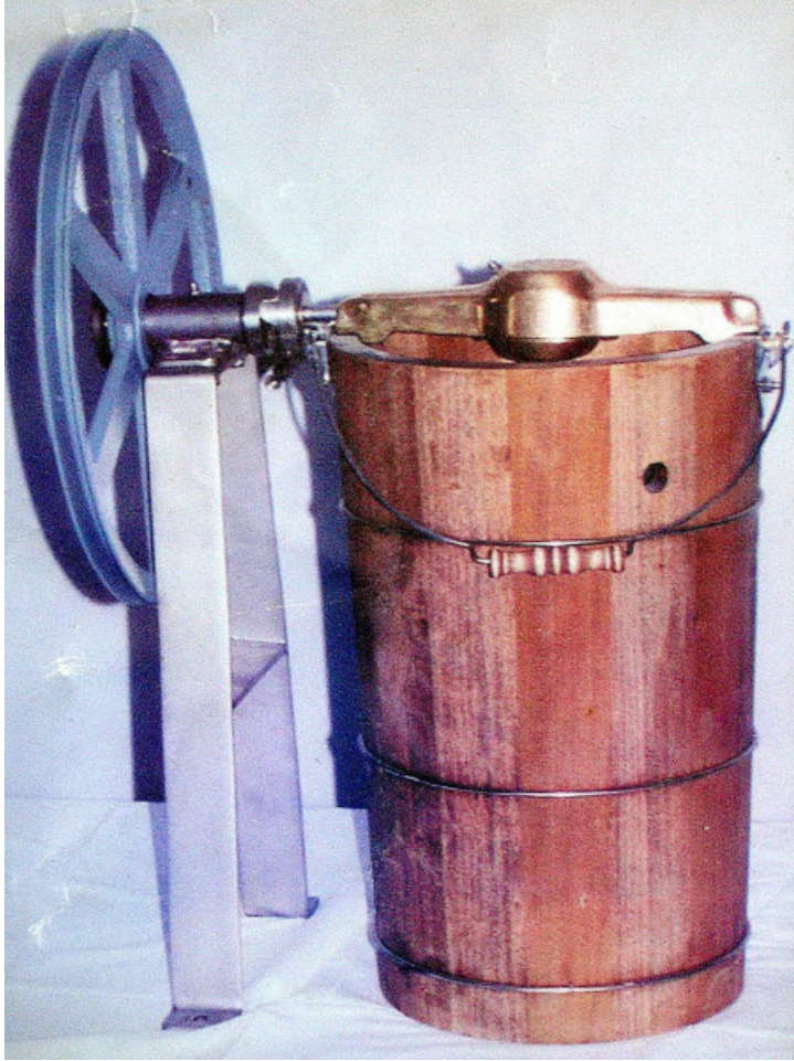
Εικόνα 1 : Χειροκίνητος παραδοσιακός μηχανισμός παραγωγής παγωτού.
