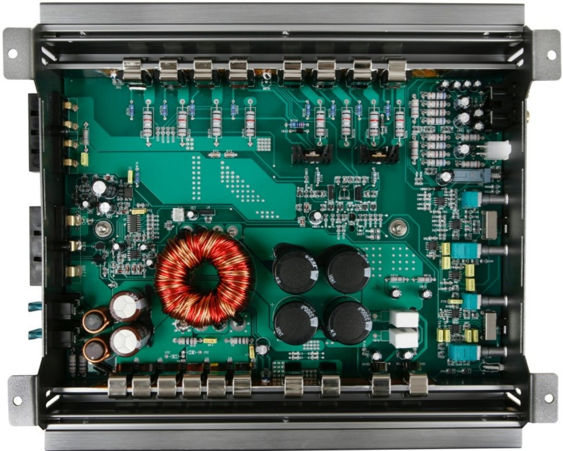
Εικόνα 4-3. Το εσωτερικό ενός ενισχυτή, τάξης AB, ισχύος 220\text{ W RMS}@4\ \Omega 8
