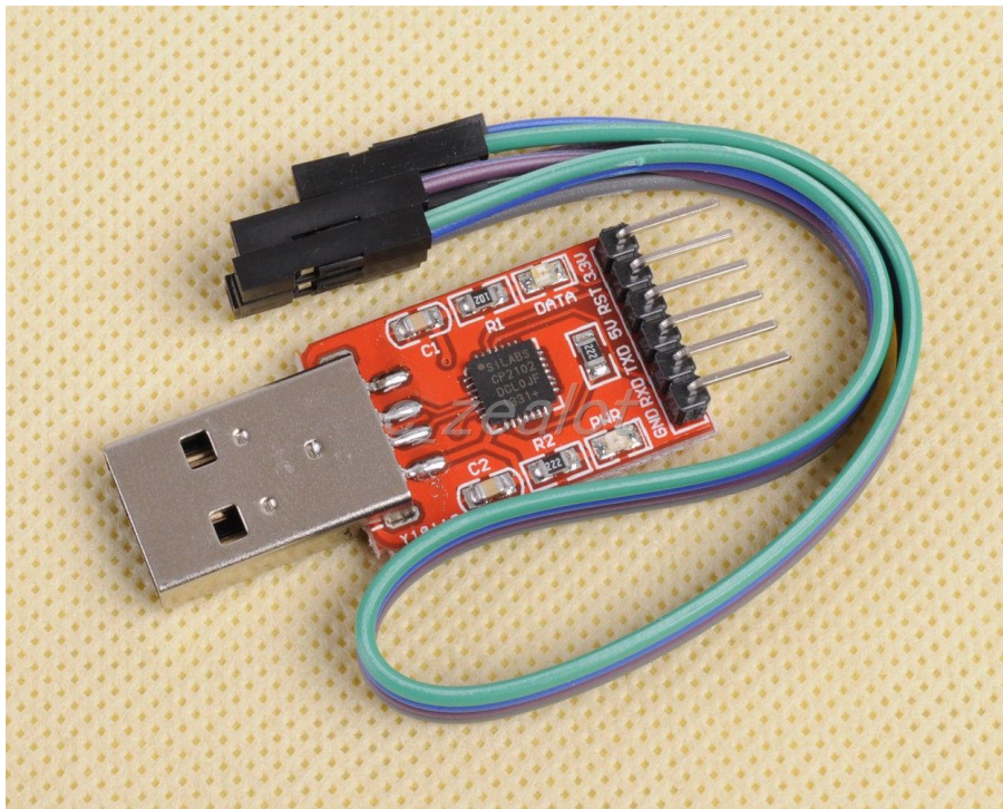
Σχήμα 2.3.1: Το σύστημα σύνδεσης του επεξεργαστή με τον υπολογιστή
