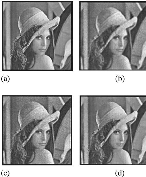
ΕΙΚΟΝΑ 25.4 (α) Αρχική εικόνα, (β) υποβαθμισμένη εικόνα στα 25 dB SNR, (γ) αποκατεστημένη εικόνα χρησιμοποιώντας Kaczmarz επαναλήψεις, και (δ) αποκατεστημένη εικόνα χρησιμοποιώντας τον τροποποιημένο αλγόριθμο Kaczmarz σε ένα πλαίσιο POCS. (Ευγενική παραχώρηση του IEEE:... Kuo, SS και Mammone, RJ, IEEE Trans. Signal Process, 40, 159, 1992)
