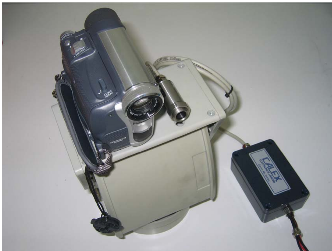
Εικόνα 3.1: Τραπέζι στήριξης με εικονολήπτη και αισθητήρα θερμοκρασίας
