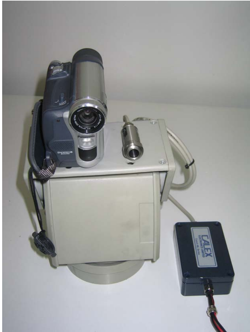
Εικόνα 2.1: Ο αισθητήρας μέτρησης θερμοκρασίας και ο εικονολήπτης πάνω στο τραπέζι σκόπευσης
