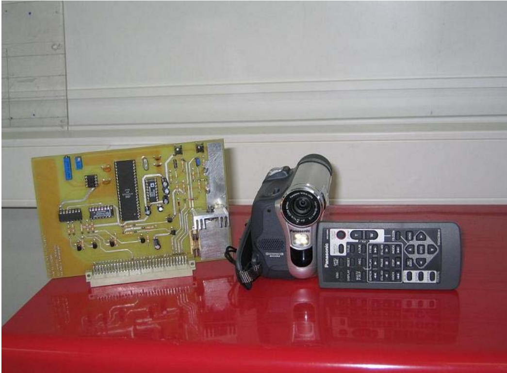
Εικόνα 4.1: Εικονολήπτης με το τηλεχειριστήριό του και το ενδιάμεσο κύκλωμα τηλεχειρισμού
